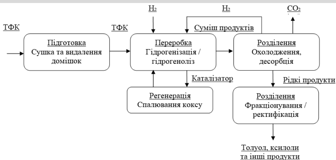
Рис. 3 Схема отримання толуолу та ксилолів з ТФК
