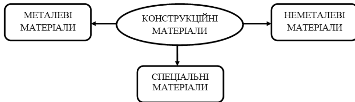
Рис. 1 Класифікація конструкційних матеріалів
