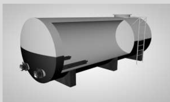
Рис. 9 Внутрішній електрообігрів днища
