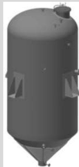
Рис. 3 Вертикальний збірник з еліптичним дахом, конічним днищем та зовнішнім підігрівачем
