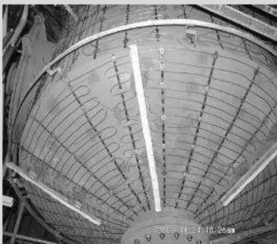
Рис. 7 Зовнішній електрообігрів днища
